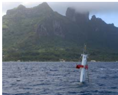
Nicht alle haben Glück. Diese Megayacht von über 30m Länge ist am Ankerplatz in der Lagune von Bora Bora gesunken. Ursache: offenbar ein abgerissener Schlauch der Seewasserkühlung des Generators.
