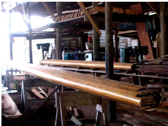
Die beiden riesigen hohlen Bäume sind mehrfach verleimt und innen mit Kohlefasern verstärkt. Mich erstaunte, wie gerade sie geschaffen sind! Ebenfalls wie die beiden Masten wurden auch sie von nur einem Mann in wochenlanger Arbeit gebaut!
