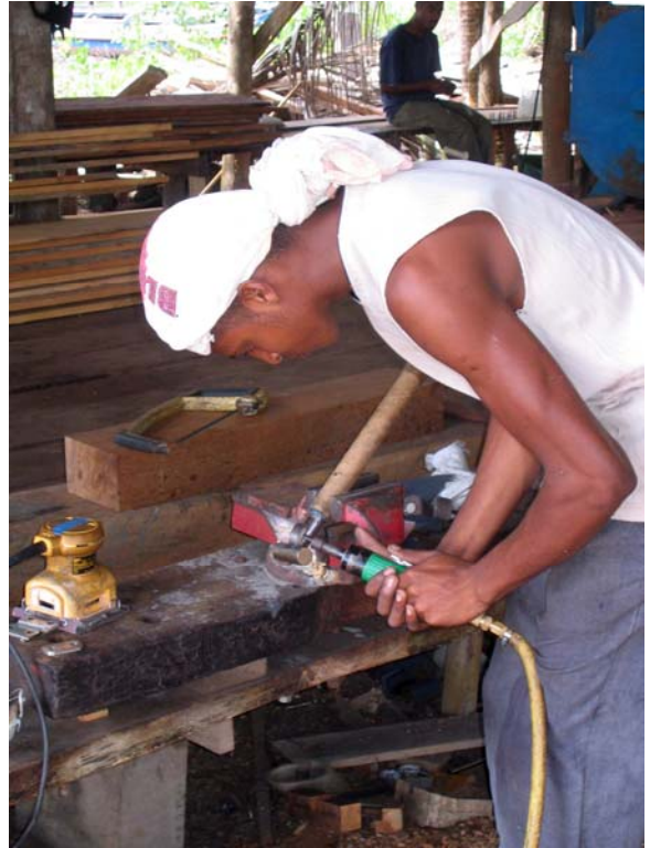
Sämtliche Beschläge aus Chromstahl werden vor Ort nach Mass fabriziert – sogar die Wantenspanner und die Teile des Rod-Riggs. Die Schleif- und Polierarbeiten verschlingen viel Zeit!
