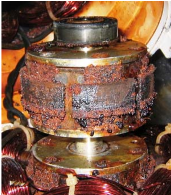
Renovaton des total korrodierten Schleppgenerators (Ersetzen der Lager) – er läuft und läßt sogar wieder!!!
