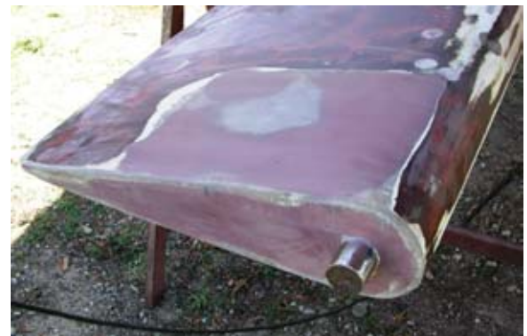
Reparieren unseres wassersaugenden Ruders (Aufschneiden – Auskratzen – Austrocknen – Neu-Einbetten des Ruderzapfens – Schäumen – Zulaminieren – Shapen)
