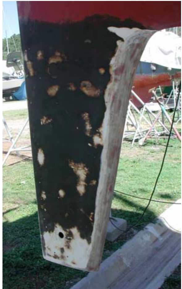
Flicken der undichten Naht am Skeg (Ausfräsen – Zulaminieren – Shapen)
