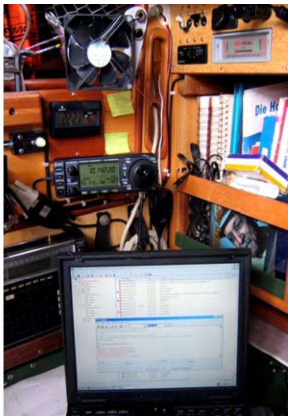
Unser <Kommunikationszentrum> am Navitisch: Laptop, Kurzwellenradio und oben rechts eingebaut das Modem (graues Gerät)
