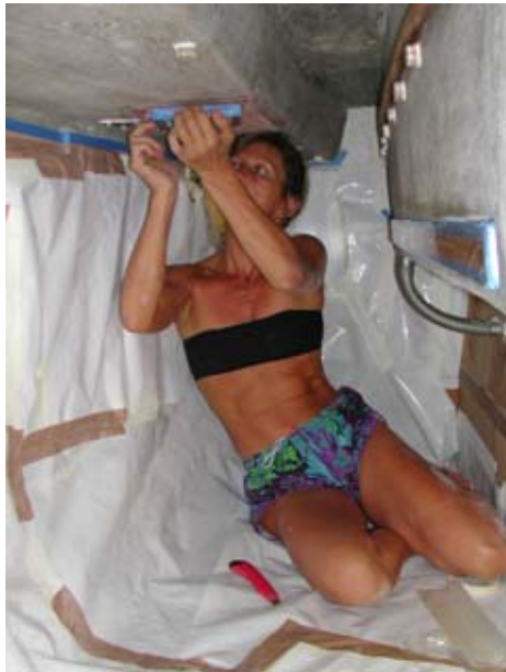
Karin in der Hundekoje am Abdecken vor der Grundierung...
