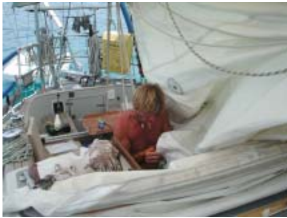
Unser Grosssegel bekommt neue Lattentaschen-Sicherungsbänder und das Achterliek einige Meter Verstärkungen: ein Arbeitstag in wunderschöner Umgebung!
